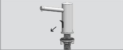
2 Verbinden Sie den Pumpenstecker mit dem passenden Stecker der Elektronikeinheit. Bitte beachten Sie, dass der Stecker wasserdicht ist und daher möglicherweise Widerstand beim Verbinden auftreten kann.
